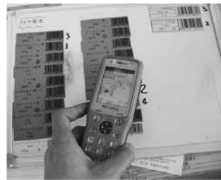
電子システムでコードを読み取り発注書をつくっています。
