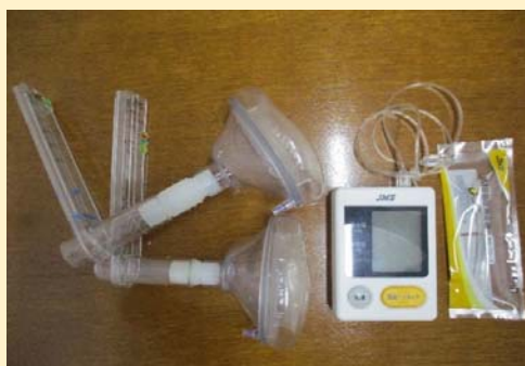
左：ピークフローメータ(咳の力を測定) 右：舌圧測定器(舌の運動機能)
